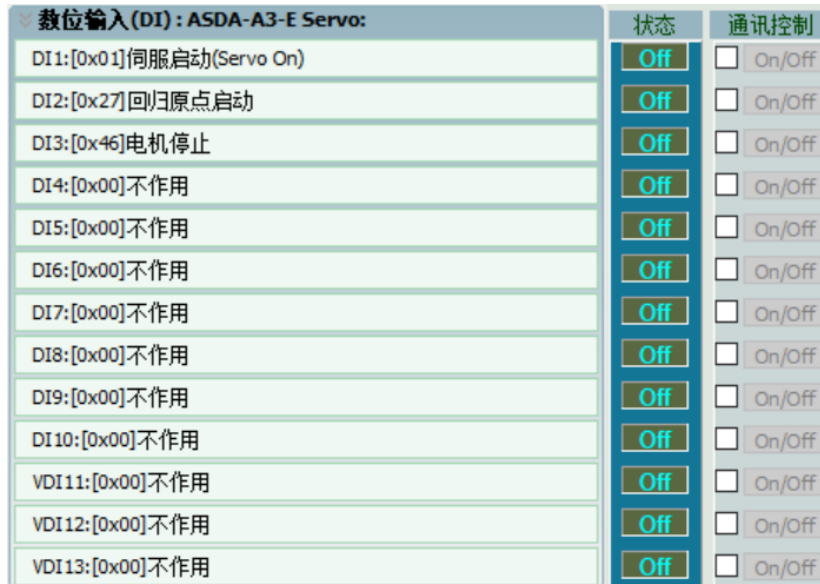
图 7.1.5.2 ASDA-Soft 软件数字 IO 设定窗口
